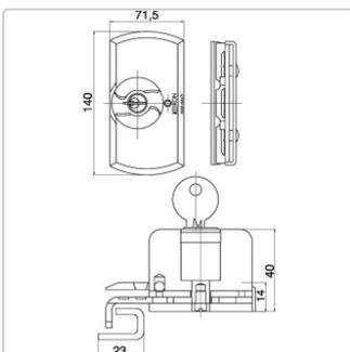
9M03,AUS=MIT DZ Fenster- und Balkontürensicherung Krallfix® 2 Mit abschließbarem Drehknopf und zwei Schlüsseln
