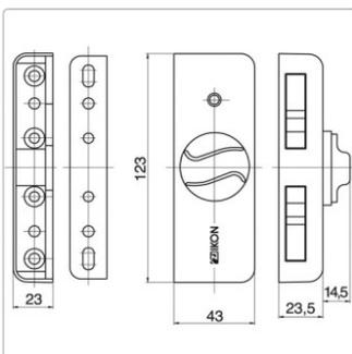
**Fenster- und Balkontürensicherung Kralltec® Mit Drehknopf**
