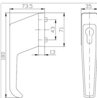
9M10,AUS=PHZ VOR Abschließbarer Fenstergriff 158 Ohne Zylinder - vorbereitet für Profil-Halbzylinder Vorteilepunkte:
