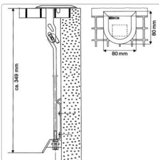
8172 Gitterrostsicherung Zusatzsicherung für Gitterroste, speziell bei Kellerschächten Produktbeschreibung:
