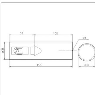
8074 Schlüsseltresorrohr Zur Wandmontage geeignet Vorteile:
