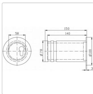
9M38,AUS=PZ VOR Mini-Tresor 179 Mit Kragen zur Abdeckung des Bohrlochs - vorgerichtet für Profil-Halbzylinder
