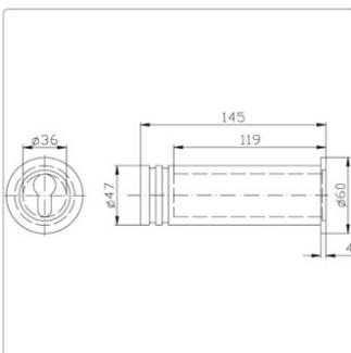
9M40,AUS=PZ VOR Mini-Tresor 178 Mit Kragen zur Abdeckung des Bohrlochs - vorgerichtet für Profil-Halbzylinder
