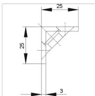
9M46 Winkel-Sicherheitsschließblech für überfälzte Türen Mit zwei Ankern [Produktbeschreibung:](#)
