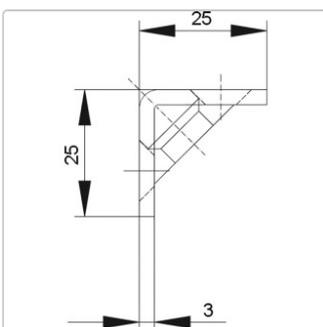
9M47,AUS=A/2 Winkel-Sicherheitsschließblech für überfälzte Türen Mit zwei Anker - Winkelkante abgerundet
