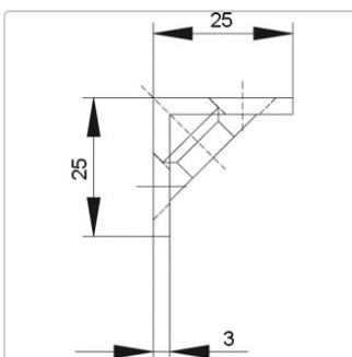
9M51 Winkel-Sicherheitsschließblech für überfälzte Türen Mit zwei Anker für Riegelschlösser Produktbeschreibung:
