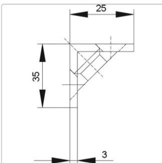
9M52 Winkel-Sicherheitsschließblech für überfälzte Türen Vorgerichtet für elektrische Türöffner - mit zwei Ankern
