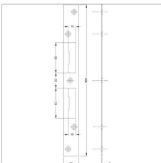
9M58 Flach-Sicherheitschließblech für stumpfeinschlagene Türen Ohne Anker Produktbeschreibung:
