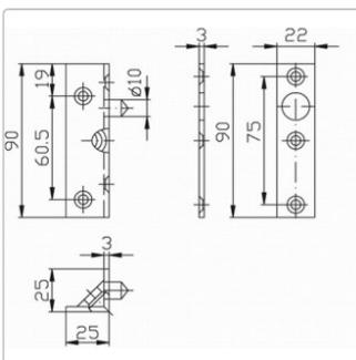
Winkel-Bändersicherung 9M17 mit Anker 260 Stiftteil winkelförmig - mit einem Anker - für Holztüren Vorteile:
