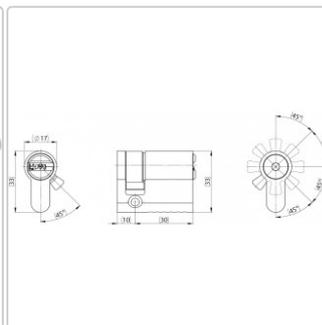
Der IKON RW6-Bohrmuldenzylinder verbindet das Außenbild hoher Sicherheit mit einem bewährten Stiftzuhaltungsmechanismus. Der RW6 basiert auf der Bohrmuldentechologie mit insgesamt 3 Sicherheitsebenen.
