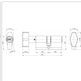
Der IKON RW6-Bohrmuldenzylinder verbindet das Außenbild hoher Sicherheit mit einem bewährten Stiftzählungsmechanismus. Der RW6 basiert auf der Bohrmuldentechologie mit insgesamt 3 Sicherheitsebenen.
