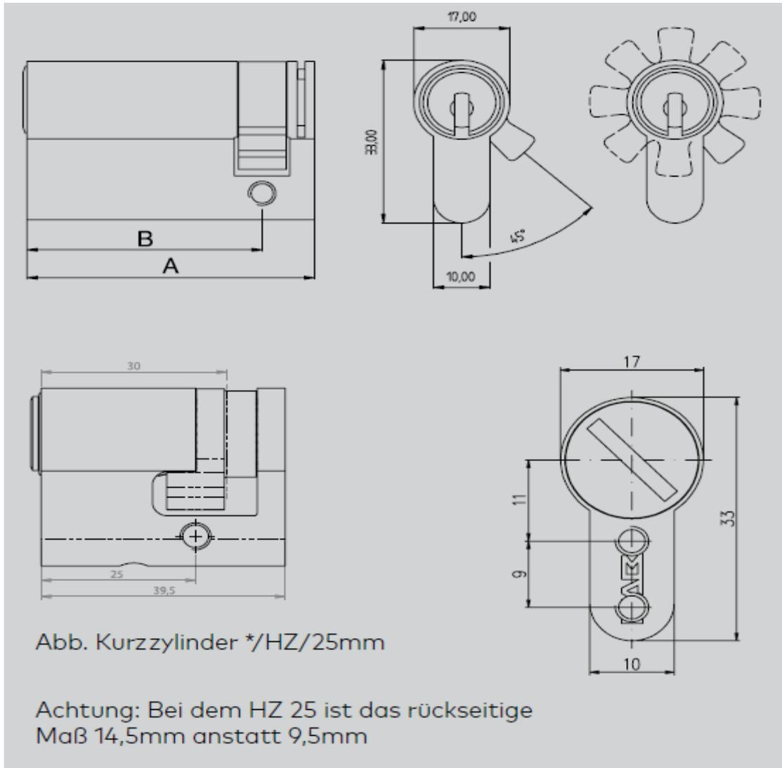
Abb. Kurzzylinder \*/HZ/25mm
